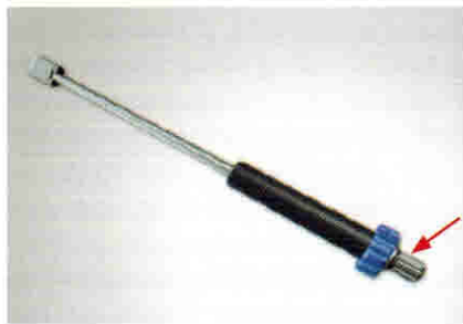
Рис. 4.80. Блокировка дистрактора в его держателе.
