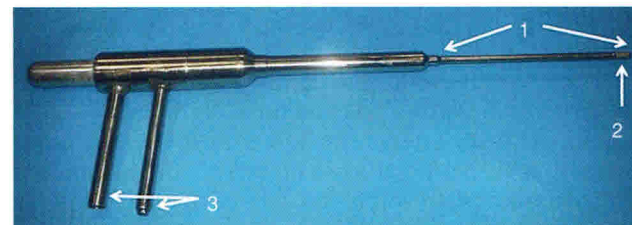
Рис. 5.1. Основные составляющие элементы криоинструмента: 1 — криозонд; 2 — наконечник — участок криозонда, где находится теплообменник; 3 — разъемные узлы для соединения с гибким подводящим криопроводом и гибким отводящим паропроводом
