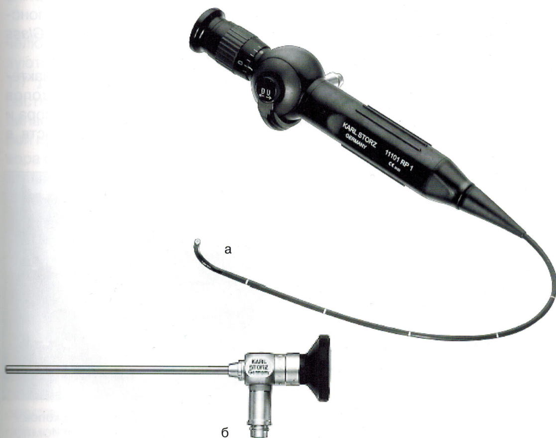
Рис. 2.2. Виды эндоскопов. а — гибкий фиброволоконный; б — ригидный линзовый.
