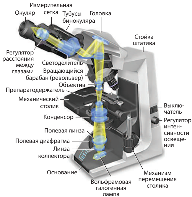
Рис. 1.3. Микроскоп светлого поля: компоненты и ход световых лучей
